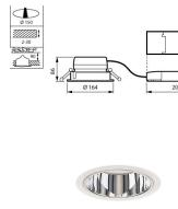
**Scheda tecnica Philips Downlight LED LuxSpace Mini Profondo DN561B 7W 840lm 75D - 830 Luce Calda | 164mm - Aluminium Riflettore**
