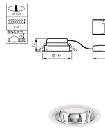
Scheda tecnica Philips Downlight LED LuxSpace Mini DN560B 7W 840lm 80D - 840 Bianco Freddo | 164mm - Aluminium Riflettore
